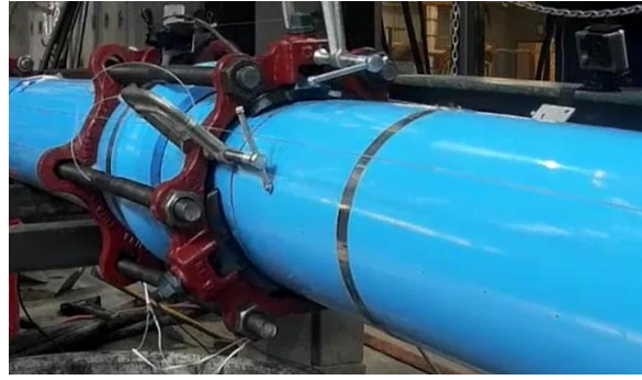
(d) Clamping Teeth Beginning to Rotate
