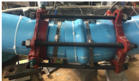
(d) Restrained Joint at Maximum Displacement
